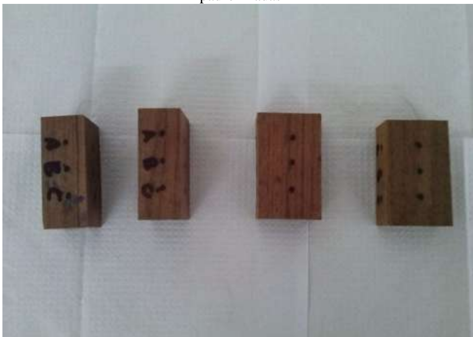
Figura 9: Corpos de prova retração demarcados pontos A, B e C, com distâncias padronizadas
