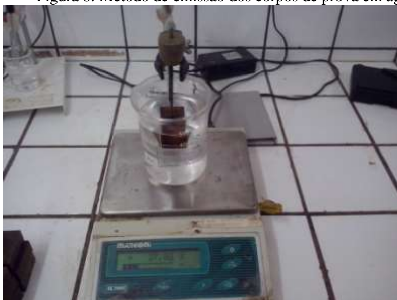
Figura 8: Método de emissão dos corpos de prova em água
